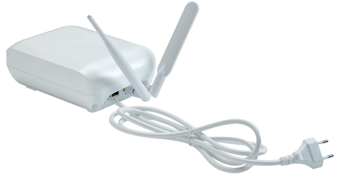
Gateway mit integriertem Netzteil und externen Antennen
